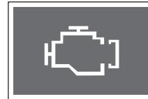
매연이 일정량 쌓였음에도 불구하고 여러가지 환경 조건 때문에 자동으로 재생이 이루어 지지 않을 수 있습니다. 이런 경우에 엔진 점검 경고등이 점멸합니다. 이런 엔진 점검 경고등 점멸은 재생 과정이 원활히 진행될 수 있도록 운전자가 적절한 운전 상태를 취하도록 하기 위함입니다.
