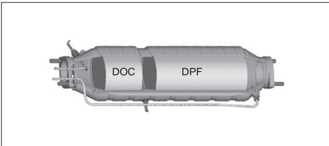
매연 저감 장치에는 DOC(Diesel Oxidation Catalyst)와 DPF(Diesel Particulate Filter)가 있습니다.
