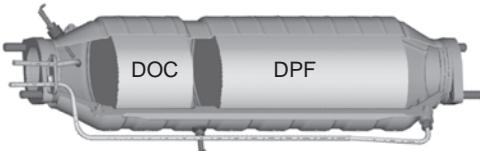
매연 저감 장치에는 DOC(Diesel Oxidation Catalyst)와 DPF(Diesel Particulate Filter)가 있습니다.
