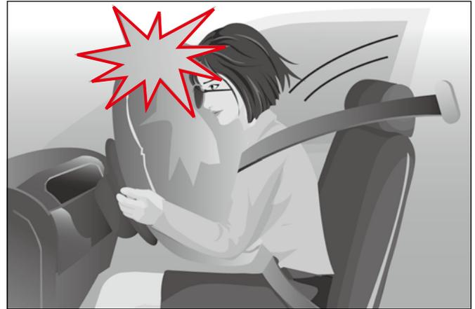
에어백은 장치에 내장된 일종의 화약을 터뜨려서 공기주머니를 순간적으로 부풀림으로써 탑승자를 보호하는 장치입니다. 따라서, 작동시에는 화약 폭발로 인한, 소음, 섬광, 연기 등이 발생하며 화상을 입을 수도 있습니다. 경우에 따라서는 에어백 공기주머니에 의한 타박상, 골절상, 찰과상, 안면 타격에 의한 안경 파손 등과 같은 피해를 입을 수도 있습니다.
