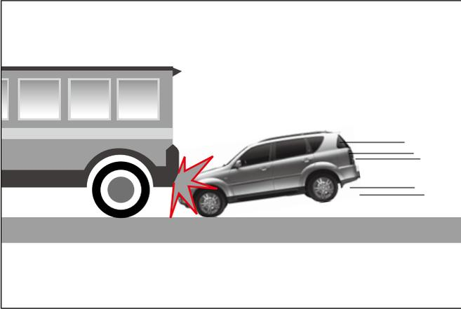
일반적으로 대부분의 운전자는 사고 발생시에 급제동을 하게 되며 이에 따라 차량의 앞부분이 낮아지는 현상이 발생합니다. 따라서, 버스나 트럭 등과 같이 차체가 높은 차량과의 사고시에는 상대 차량의 차체 밑으로 끼어 들어가는 경우가 많이 발생합니다. 이러한 경우에는 에어백이 작동하지 않을 수 있습니다.
