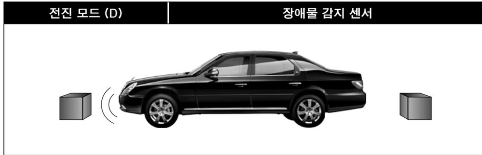
차량 전진 모드(D 또는 1, 2, 3, 4)에서는 전방 장애물 감지 센서만 작동
