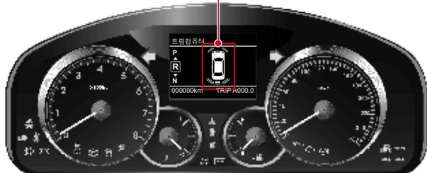
**참고** 계기판 전시 상태는 장애물과의 거리를 나타내며 센서 상태 및 장애물과의 위치 상태에 따라 다소 차이가 날 수 있습니다.
