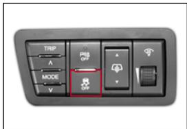
눈길 또는 빙판길에서 좌우 구동바퀴에 계속 해서 슬립이 발생할 경우, 엔진 구동력 제어로 인하여 가속페달을 밟았음에도 불구하고 엔진 회전수가 상승하지 않아 출발이 힘들 수 있습니다. 이때, **ESP OFF** 스위치를 누르면 (계기판의 ESP 표시등 점등) ESP 기능이 해제되면서 보다 쉽게 출발할 수 있습니다.
