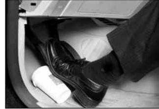
브레이크 페달 또는 가속 페달 작동 부위에 캔이나 기타 물체가 있을 경우 차량 제어가 되지 않아 매우 위험합니다. 주행 전 반드시 확인 바랍니다.
