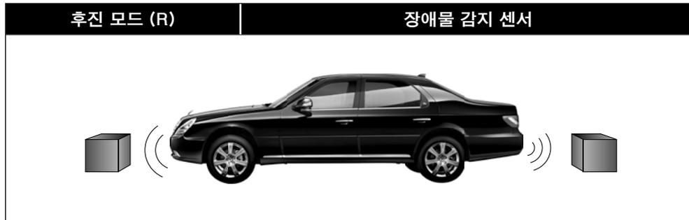
차량 후진 모드(R)에서는 전방 및 후방 장애물 감지 센서가 함께 작동
