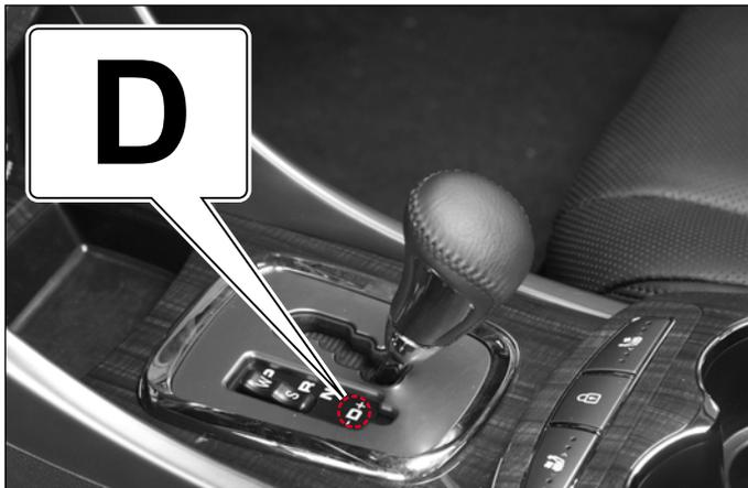
평상시의 일반도로 및 고속도로 주행시의 선택레버 위치로써 차량 속도와 가속 페달을 밟는 정도에 따라 자동으로 기어가 전환됩니다(1단~5단).
