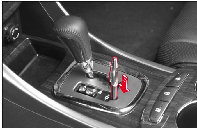
선택레버를 **P** 위치에서 다른 위치로 이동하기 위해서는 시동 스위치가 **ON** 위치에 있고 브레이크 페달을 밟은 상태여야 합니다. 시동 스위치 **ON** 위치에서 브레이크 페달을 밟았음에도 불구하고 레버가 **P**에서 이동되지 않으면 다음과 같이 수동으로 이동하십시오.
