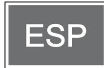
ESP OFF 스위치를 눌러 ESP 기능을 해제하면 ESP 경고등이 점등됩니다. 또한 ESP 기능이 작동중일 때에는 ESP 경고등이 점멸합니다.
