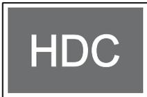
HDC 스위치를 누르면 HDC 작동 대기 상태로 전환되면서 계기판에 녹색 HDC 표시등이 점등됩니다. 다시 한번 HDC 스위치를 누르면 계기판에 HDC 표시등이 소등되면서 HDC 기능이 해제됩니다.
