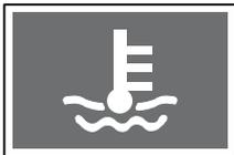
엔진 냉각수 온도가 높으면 엔진 과열 경고등이 점멸하면서 부저가 울립니다. 경고등이 점멸하면 차량 주행을 삼가하시고 차량을 안전한 곳에 정차시켜 엔진을 식히십시오. 자세한 내용은 11단원의 엔진이 과열되었을 때의 대처방법을 참고하시기 바랍니다.
