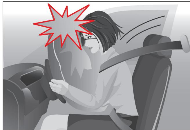
에어백은 장치에 내장된 일종의 화약을 터뜨려서 공기주머니를 순간적으로 부풀림으로써 탑승자를 보호하는 장치입니다. 따라서, 작동시에는 화약 폭발로 인한, 소음, 섬광, 연기 등이 발생하며 화상을 입을 수도 있습니다. 경우에 따라서는 에어백 공기주머니에 의한 타박상, 골절상, 찰과상, 안면 타격에 의한 안경 파손 등과 같은 피해를 입을 수도 있습니다.
