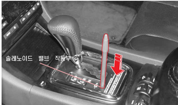
선택 레버를 **P**위치에서 다른 위치로 이동하기 위해서는 시동키가 **ON** 위치에 있고 브레이크 페달을 밟은 상태여야 합니다. 시동 키 **ON**위치에서 브레이크 페달을 밟았음에도 불구하고 레버가 **P**에서 이동되지 않으면 다음과 같이 수동으로 이동하십시오.
