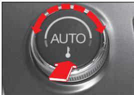
다이얼을 누르면 LCD 표시창에 [AUTO]가 표시되고 송풍량과 송풍방향이 자동조절되면서 설정 온도로 실내 온도가 유지됩니다. 다이얼을 돌려 송풍 설정 온도를 조절할 수 있으며 수동 작동 상태일 때 자동 작동 스위치를 누르면 다시 자동 작동 상태로 복귀합니다.
