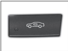
AQS가 작동하고 있는 동안 유해가스 감지 센서가 유해가스를 감지하면 내기 순환으로 전환되면서 내/외기 선택 스위치의 표시등이 점등됩니다. 유해가스 지역을 벗어나 다시 외기 유입 상태로 전환되면 내/외기 선택 스위치의 표시등이 소등되면서 외기 순환으로 전환됩니다.
