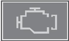
엔진의 연료 시스템이나 주요 전기적인 장치에 이상이 발생했을 경우 계기판의 엔진 점검 경고등이 점등됩니다. 이럴 경우 엔진 구동력이 감소하거나 엔진시동이 꺼지는 증상이 나타날 수 있습니다. 이와 같은 현상이 나타나면 당사 정비사업장을 방문하셔서 점검 및 정비를 받으시기 바랍니다.
